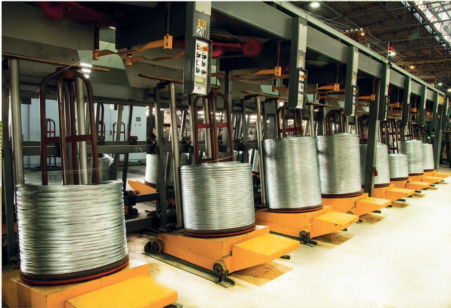
**METALURGIA SA** besitzt eine moderne Anlage für die Feuerverzinkung von Drähten mit voller Kontrolle technologischen Vorgangs, was ermöglicht, die höchste Qualität des verzinkten bei der Herstellung des Knotengitters verwendeten Drahtes zu erlangen. Hervorragende Festigkeitsparameter sowie dichter Zinkmantel versichern die Langlebigkeit des Gitters.
